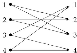
Dieser Kanal hat (analog zu Teilaufgabe b)) Kapazität 1 (es wurden lediglich die Outputs permutiert). Weiter ist der Output bei einer Serieschaltung zweier solcher Kanäle für jeden Input gleichverteilt, die Kapazität von  $K'$  also 0.
