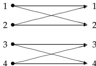
Dieser Kanal hat Kapazität 1, da er äquivalent zu einem binären fehlerfreien Kanal ist. Eine andere Lösung ist der folgende Kanal, wo alle Übergangswahrscheinlichkeiten 1 sind:
